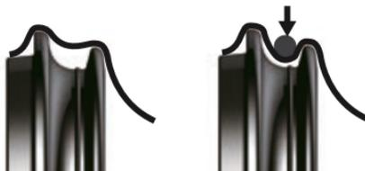
**3.** Die Materialüberlappung wird jetzt über den O-Ring zurückgeschlagen und durch ziehen gleichmäßig eingestellt. Abdeckung gemäß Abbildung einsetzen. Der Abdeckung muss sauber neben dem O-Ring liegen und diesen samt umgeschlagenem Material bedecken.
