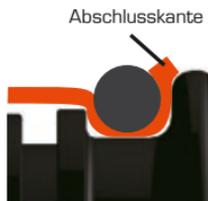
**3.** Die Latexmanschette, über den Anzugring samt Silikonmanschette, bis zum Ende des Anzugrings ziehen. Die Latexmanschette zentrieren und den O-Ring gemäß Abbildung in die Nut einsetzen.
