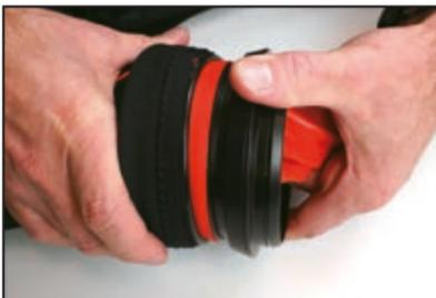
**7.** Gerade und unverkettet bis zum einrasten weiterschieben. Entweder „klickt“ das einrasten und/oder der Anzug schließt bündig mit dem Ring ab. Jetzt muss überprüft werden, ob die Silikonmanschette sauber und faltenfrei anliegt.
