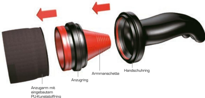
**1.** Jetzt muss der feste ovale Ring aus dem Anzugarm entfernt werden. Falls notwendig, unter Verwendung des mitgelieferten Werkzeugs. Vor weiterer Verwendung wird nun die Ammanschette aus Beschädigungen überprüft.
